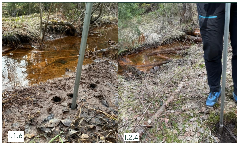
Figur 53. Sedimentprøver i øvre del av Ilabekken fra bekkeløpet (t.v.) og jordprøver fra bekkkanten (t.h). Prøvepunktene ligger like etter utløp av drenerørret fra rifle- og leirduebanene. Bekken er farget rustrød av jernutfellinger.
