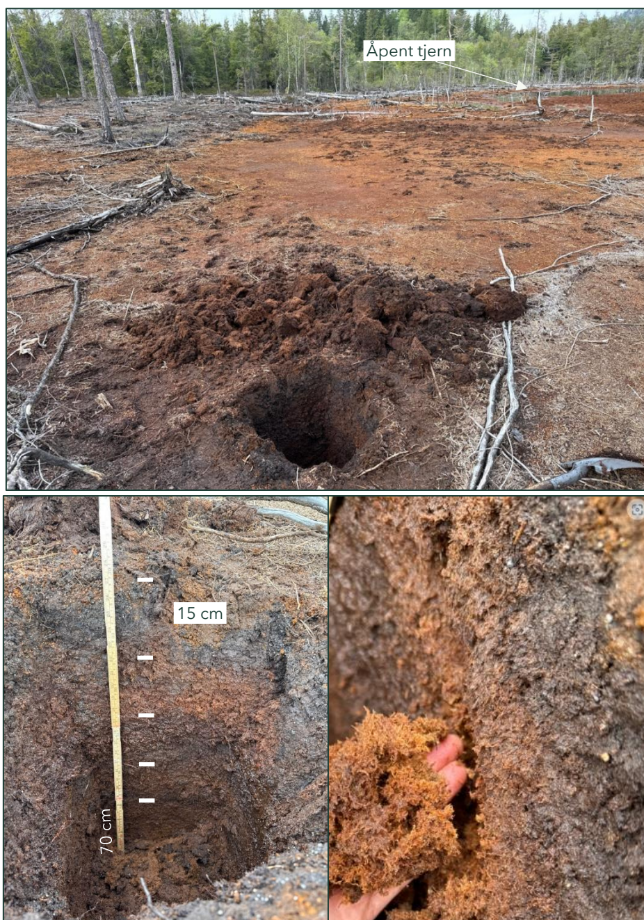
Figur 29. «Gravd hull» på 0,7 m dybde innenfor tiltaksområde 1.1, se plassering på Figur 30. Hull gravd nærmere tjernet ble raskt fylt med vann.
