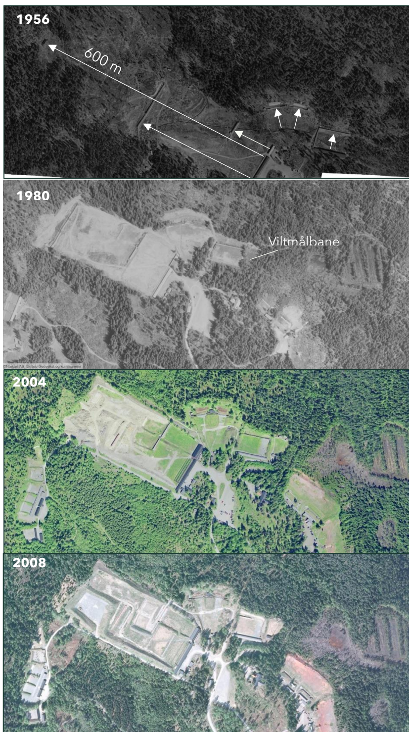
Figur 5. Flyfoto av Løvenskioldbanen fra 1956, 1980, 2004 og 2008. Plasseringen av skytebanene og skyteretningen har i stor grad vært lik fra banene ble bygget til i dag. Flyfoto fra 1980 viser at miniatyrbanene er utvidet i østlig retning med dagens viltmålbane, og det er gjennomført gravearbeid på riflebanene. I 2004 viser flyfoto utvidelse av pistolbanene med feltbaner, gravearbeid i forbindelse med etablering av nye voller med tilkjørte masser på riflebanene. Terrenget foran standplass på leirduebanene er også fylt ut sammenlignet med flyfoto fra 1980.
