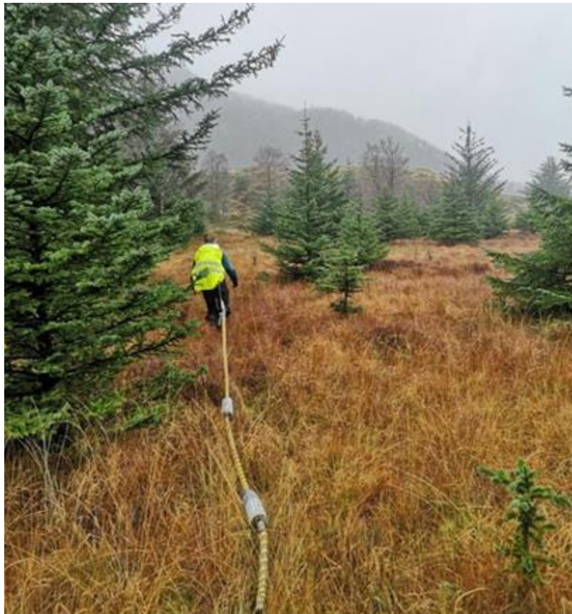
Figur 2 Bilde som viser oppsett av georadar i felt
