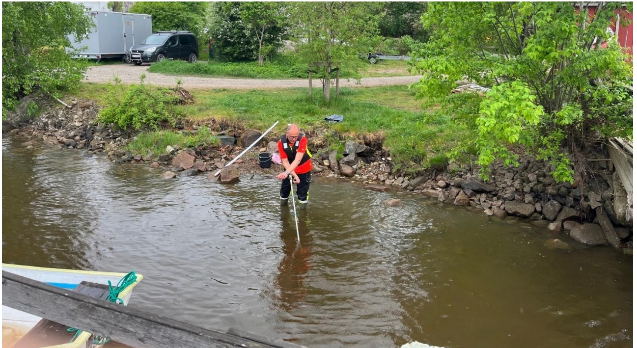
Figur 5. Bildet viser prøvetaking av sedimenter med hjelp av håndholdt jordbor.
