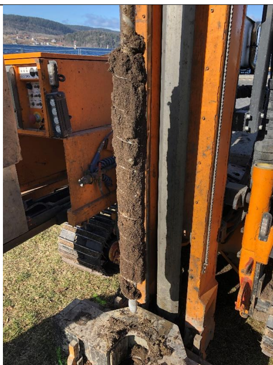
Bilde 19: Prøve M9, 0-1 m. Hovedsakelig jord/sand. Noe innslag av tegl.
