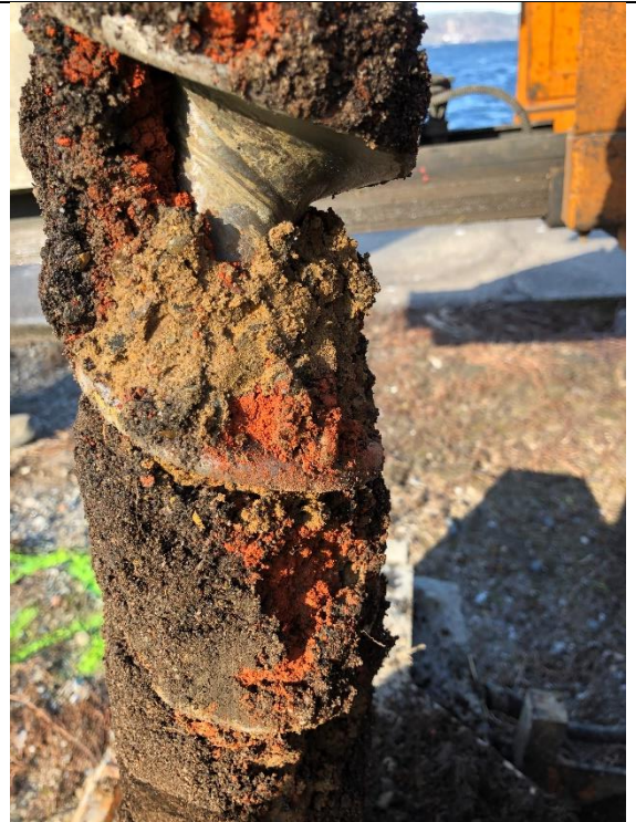
Bilde 10: Prøve M6, 0-1 m. Innslag av teglstein og lysere masser.
