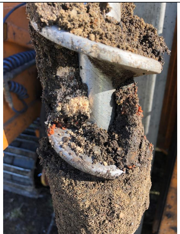
Bilde 8: Prøve M5, innslag av tegl og lysere masser.
