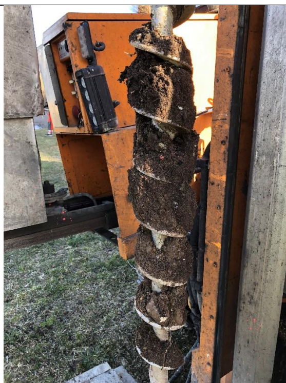
Bilde 20: Prøve M10, 0-1 m. Innslag av noe tegl og noen mindre områder med lysere masser.
