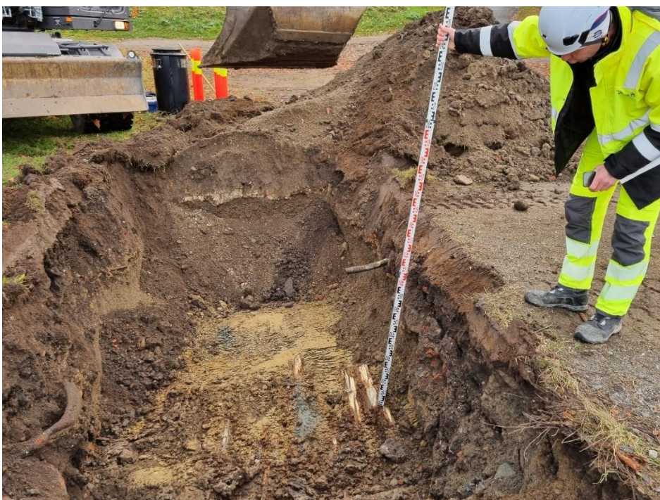
Figur 6: Prøvegrop 5, trevirke påvist i ca. 1,2 m dybde.
