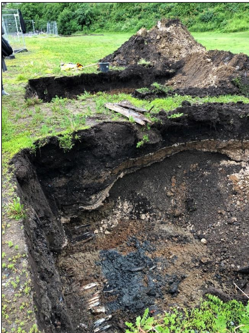
Figur 1-9. Bilde som ble tatt av en av sjaktene (prøvegrop 2X) under den geotekniske prøvegravingen som ble gjennomført 12. juni 2019 (bildet er hentet fra Sweco-notat 10211903-N01 «Notat Prøvegraving 12.06.2019»). Bildet viser tydelig innslag av lysere partier i masseneet område med jord med en blågrå farge.
