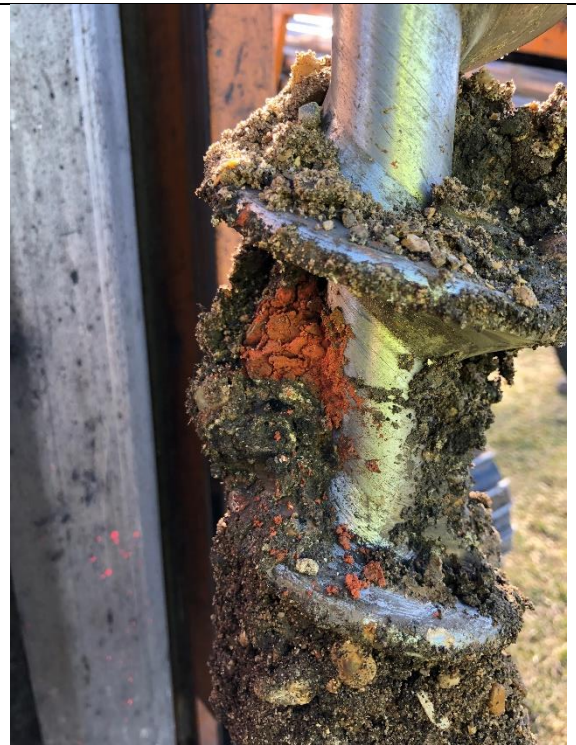
Bilde 6: Prøve M4, innslag av tegl. Tydelig av massene er fyllmasser.
