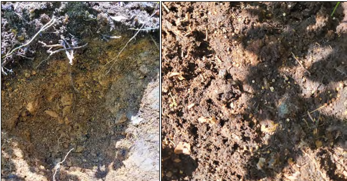
Figur 13. Massene ved HS404 består av et tynt lag av torvjord og underliggende lys sand og grus. I torvjorda var det mye synlig blyhagl.
