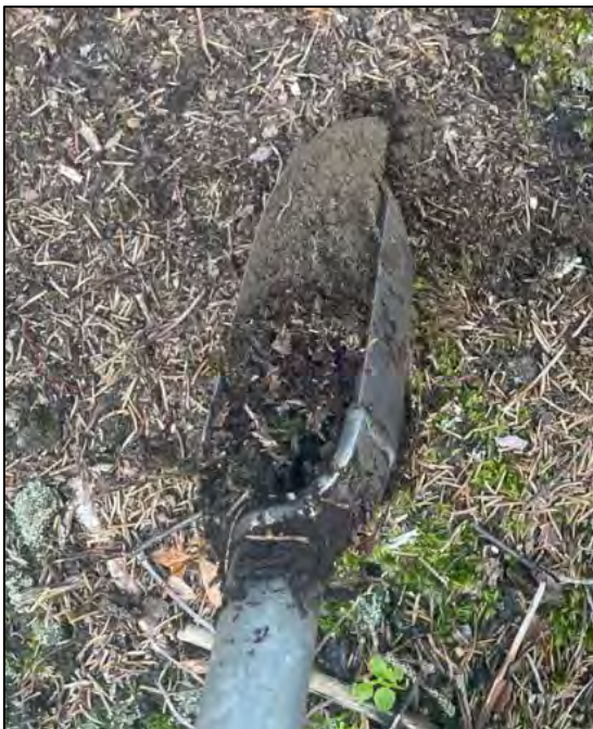
Figur 6. Bilde av skovl fra HS202. På østsiden av Ørfiskebekken består massene ved HS201-HS202 av et organisk lag i toppen med grå sand under.
