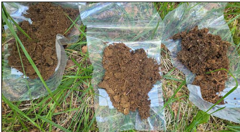
Figur 14. Masser fra HS504 består av organisk rik jord i toppen med brun sand og grus under.
