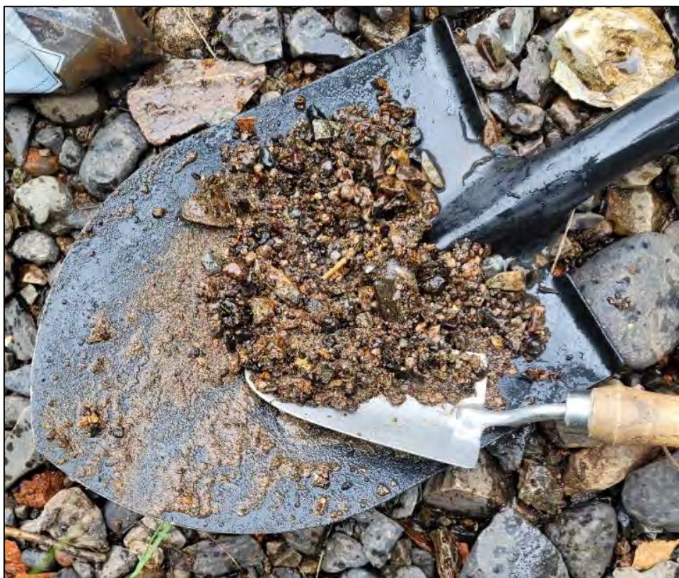
Figur 19. Sedimentene i Ørfiskebekken er generelt grove og med lite sand.
