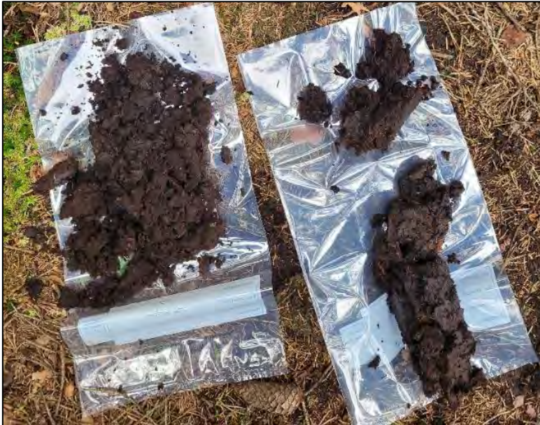
Figur 12. Bilde av massene fra HS404 i øverste 25 cm til venstre og 25-50 cm til høyre viser at massene går over i en bløt/våt jord i dybden.
