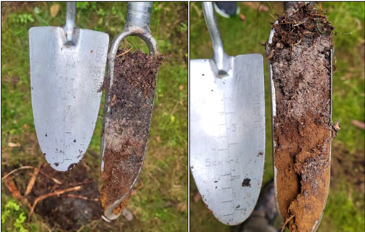
Figur 16. Podsol-profil fra BG1 t.v. og BG2 t.h. Profilet fra BG1 har et tykkere organisk lag enn BG2. Begge viser overgang fra utvasket grå sand til en jernrik/rustbrunt utfellingslag.
