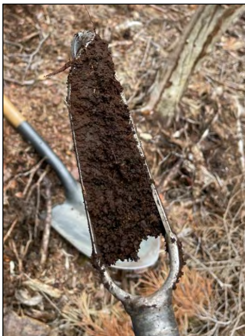
Figur 7. Bilde av skovl ved HS305. Massene ved HS203-HS305 bestod av mørk organisk rik jord (mold).
