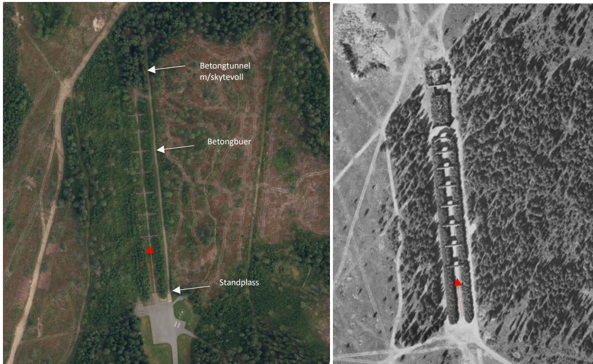
Figur 3 Venstre: Flyfoto fra 2022. Tanksskytebanen består av standplass, åtte betongbuer og en betongtunnel med oppbygget voll i enden. Det har blitt skutt gjennom alle betongbuene fra sør mot nord (vist med rød pil). Høyre: Historisk flyfoto som viser banen fra 1953. Kilde: kart.finn.no
