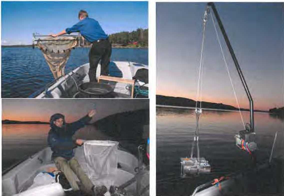
Figur 2. Utstyr som ble benyttet til å kartlegge istidskreps. T.v. øverst bunntål, nederst mysishov. T.h. Van Veen-grabb koblet til vinsj. I tillegg ble en vanlig planktonhov benyttet til å registrere hoppekrepsene flammekreps og eurytemora. Foto: Jan P. Vaaler (t.v.) og Ingvar Spikkeland.
