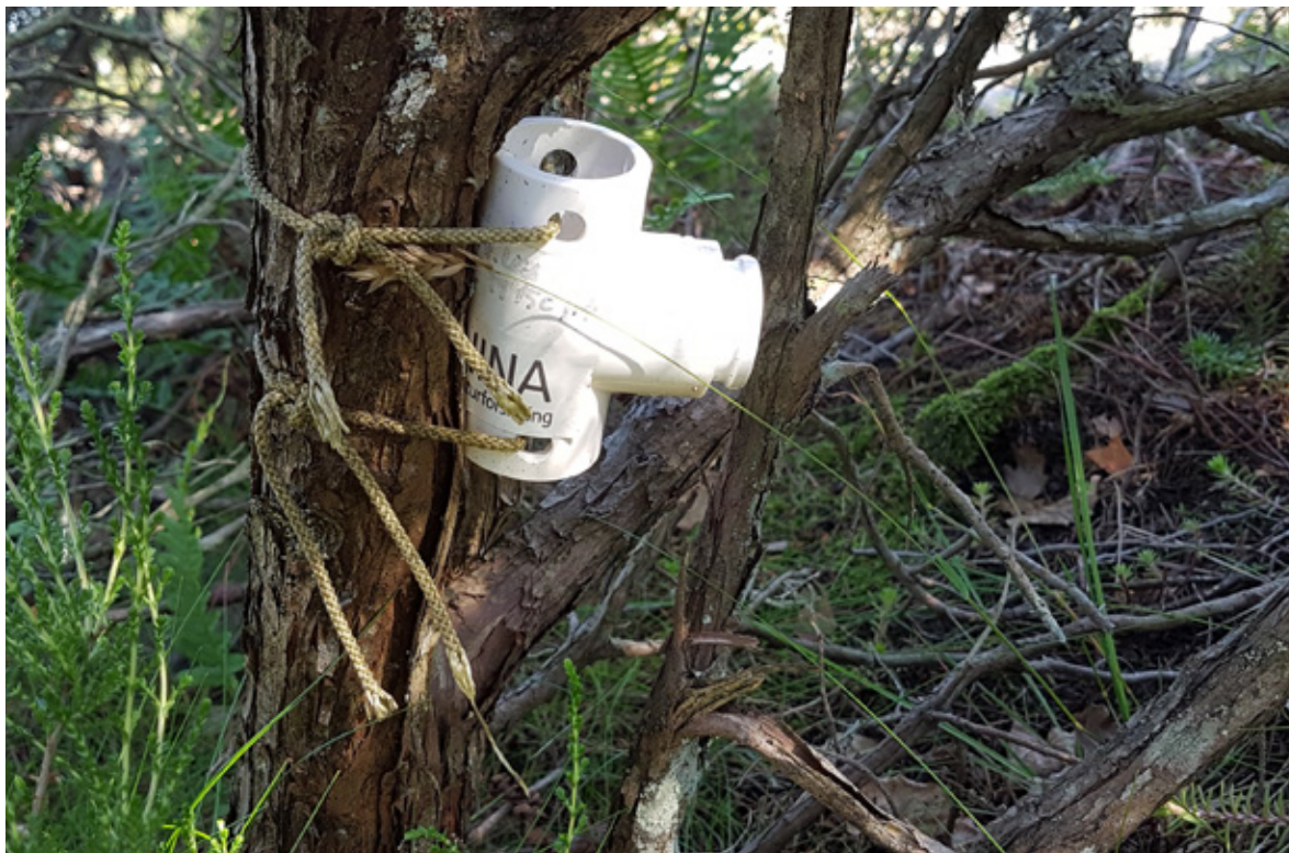
Figur 115. Temperaturlogger fra Halden. Loggeren står horisontalt inn i et hvitt hylster av plast og logger temperatur og relativ fuktighet omkring seks ganger pr. dag gjennom året. Foto: Anders Endrestøl.
