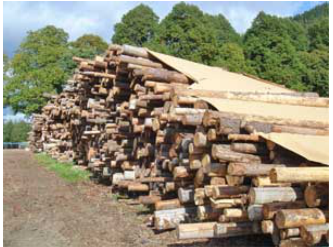
Lagring og tørking av virke
