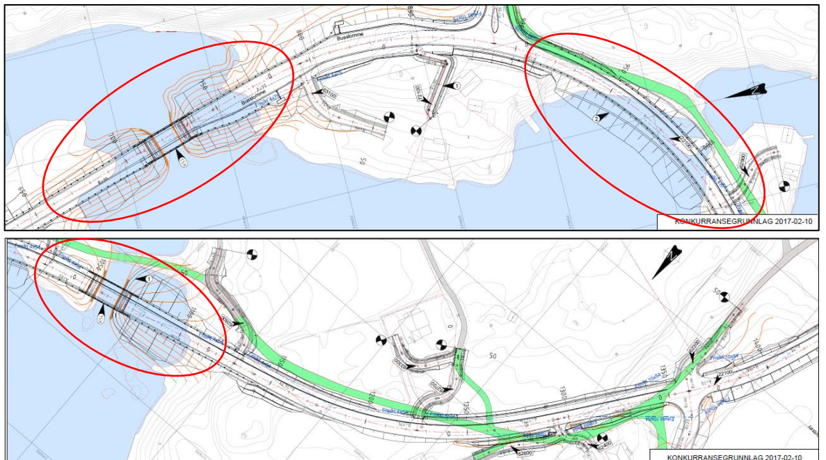
Figur 5 Utsnitt fra D-tegninger 02-Z01-503 og 504 med brukryssing over Kyrkjøysundet nord (K53) og vegfylling og brukryssing over Kyrkjøysundet sør (K54).
