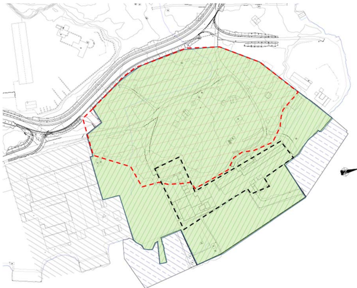
Figur 5. Grønt areal viser planert areal etter tiltak (kote + 2,37), rød stiplet linje markerer området som skal sprenges ned til kote + 2,37. Forurensede løsmasser ønskes mellomlagret på dagens kaiområde (markert med svart stiplet linje).
