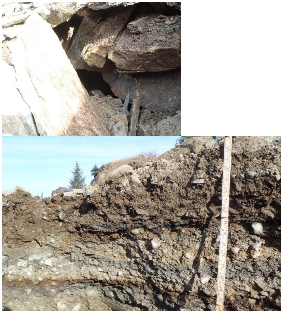
Figur 13: Sjakt 9. Stor blokkstein, med hulrom mellom blokkene, tydelig lagdeling i de øverste massene.
