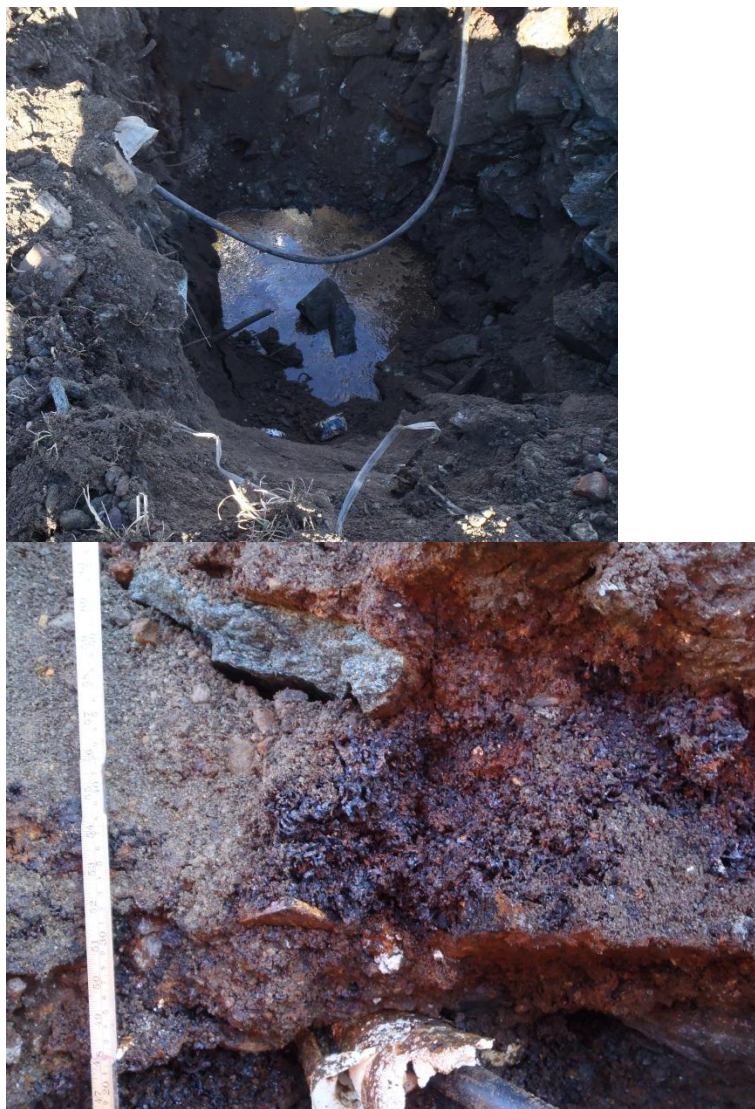
Figur 10: Sjakt 6. Påtraff sjøvann på 220 cm, oljefilm på overflaten. I profilet var det lag av oksidert dreiespon.
