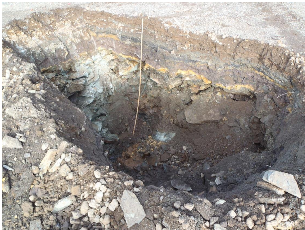
Figur 14: Sjakt 11, Tydelig lagdeling i overflatemassene ned til 50 cm.
