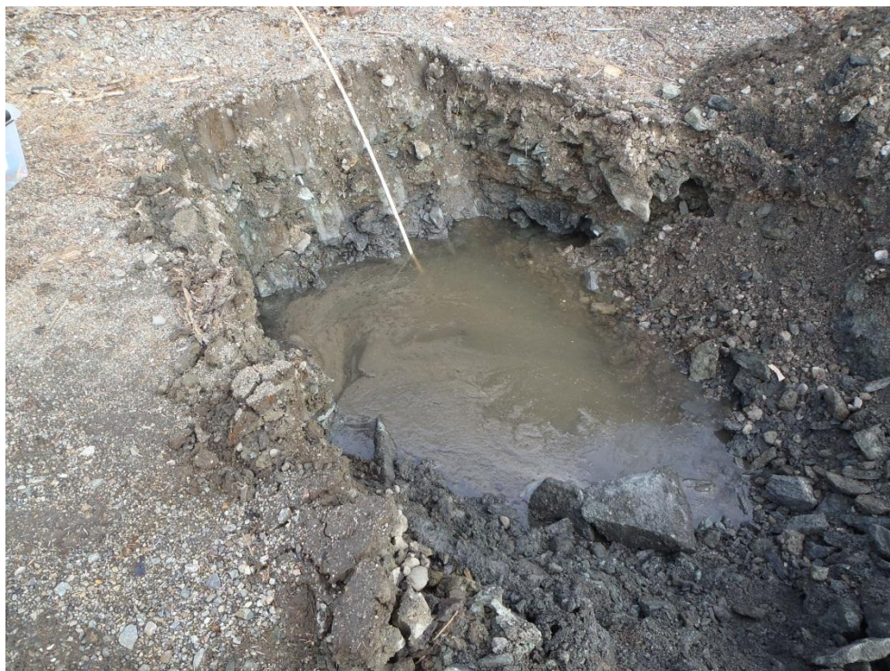
Figur 16: Sjakt 14, oljefilm på overflaten av grunnvannet.
