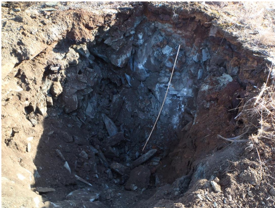
Figur 11: Sjakt 7. De øverste 50 cm består av dreiespon som har oksidert til en stor sammenhengende flate. Underliggende masser er svært forvitret grønnstein.
