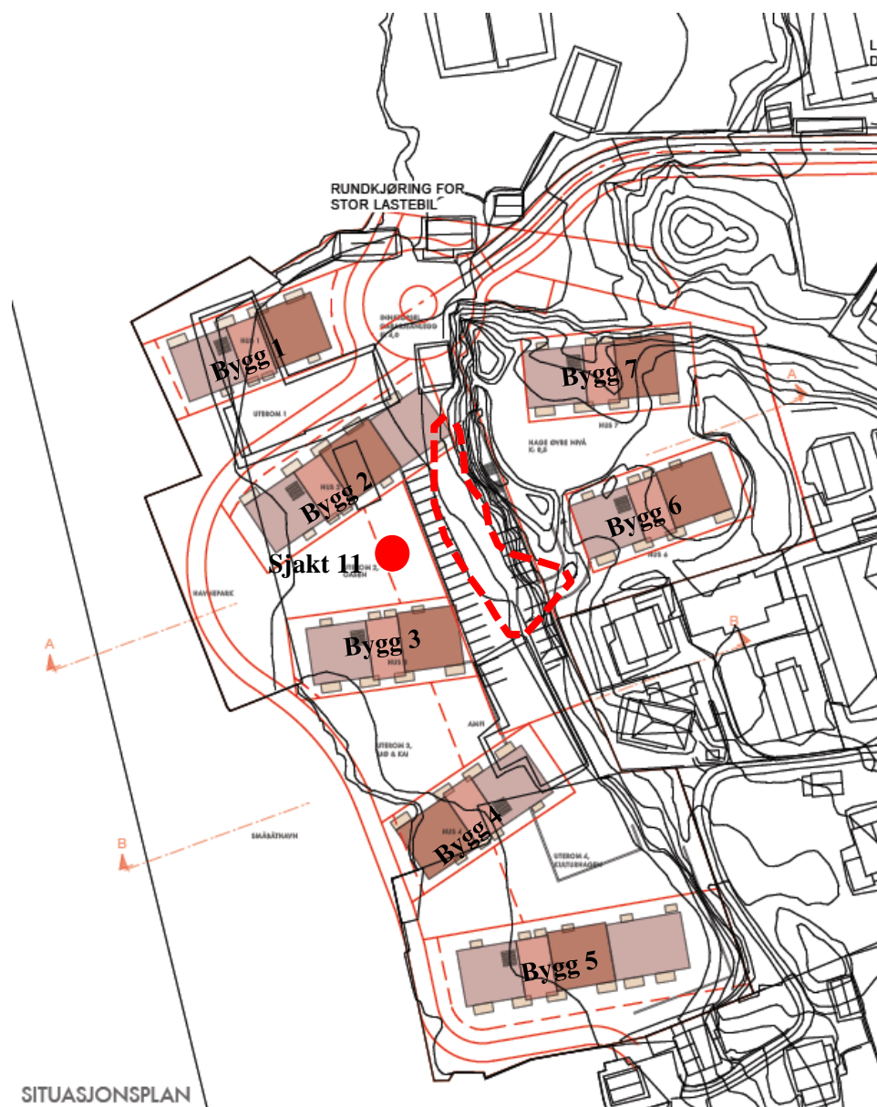
Figur 4: Situasjonsplan med planlagt utbygging. Sjakt 11 er markert med rødt punkt og oljeforurensnet område er markert med stiplet linje.
