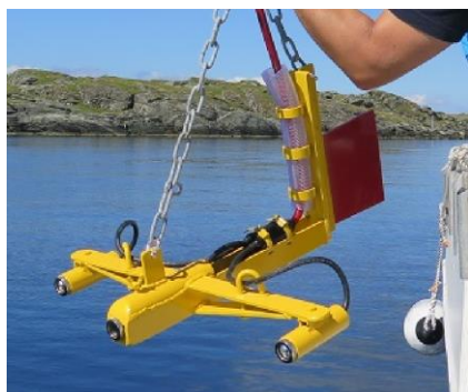
Figur 8. Hardbunnslokaliteter i Egersund havneområde ble dokumentert ved fotografering med kamera påmontert en rigg med utstyr for logging av vanddyb og posisjon.
