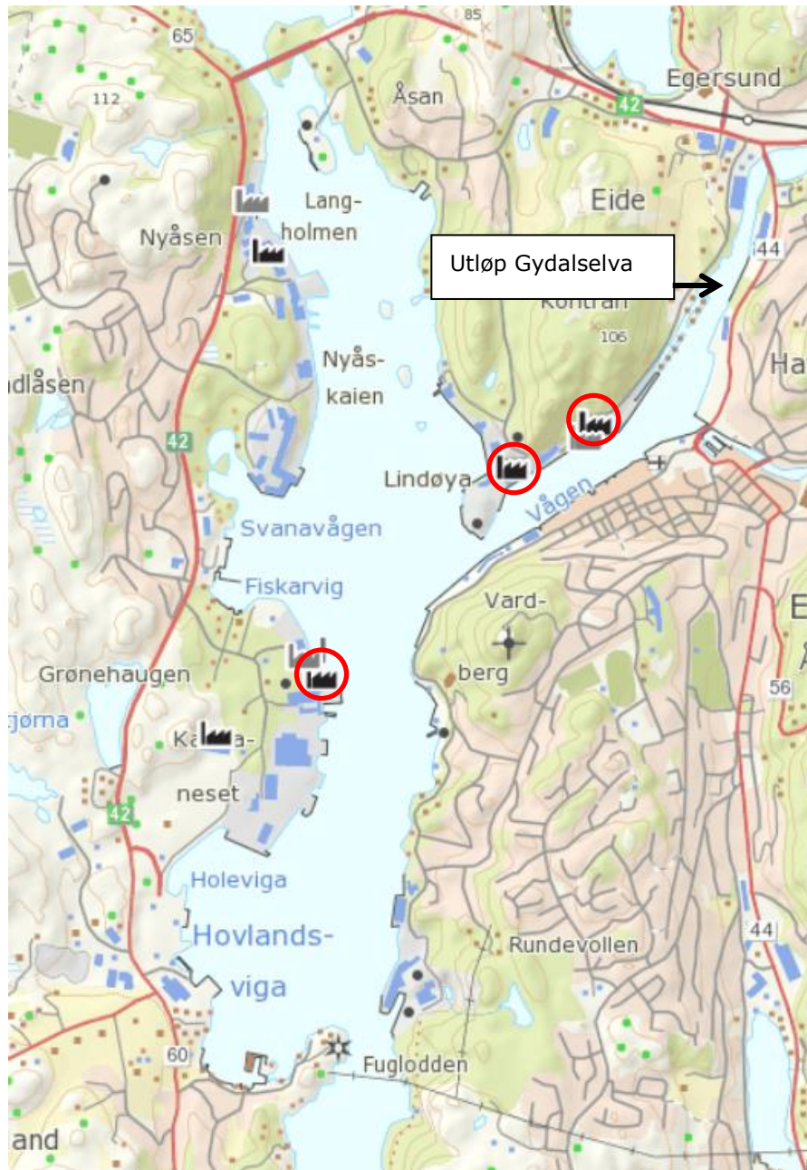
Figur 6. Forurensningskilder i, og i nærheten av resipienten. Fabrikken med grå skravering er nedlagt, mens svart skravering indikerer fortsatt drift. Fiskeindustriens anlegg er markert med rødt omriss. Bjerkreimselva har utslipp nord for resipienten (jf. Figur 1) og Gydalselva har utløp i Egersund havn. Begge kan bidra med forurensning til resipienten.
