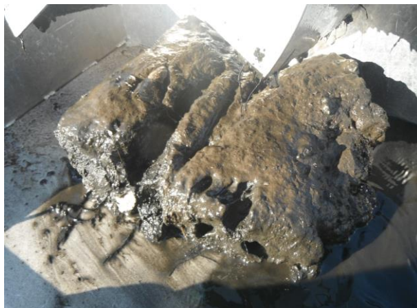
Figur 10. Sedimentene i Egersund havn besto hovedsakelig av silt og sand med et topplag av brunt organisk materiale. I flere prøver var det lukt av H 2 S.
