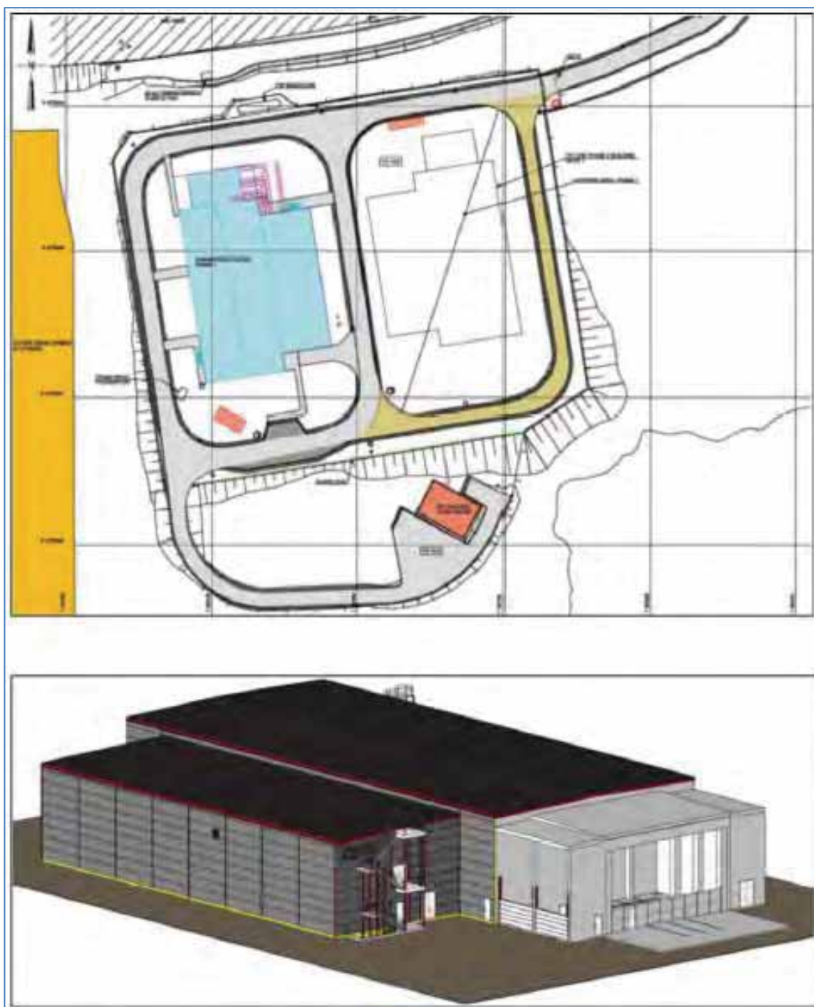
Figur 8 Foreløpig planløsning og skisse av omformerstasjon, utbyggingsfase 1
