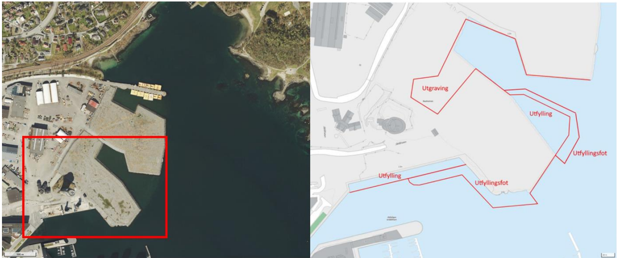
Figur 1: Tiltakene er planlagt i Jåttåvågen ved eiendom 17/1462 i Stavanger kommune. Det er planlagt utgraving av eksisterende utfylling, samt nye utfyllinger, og peling/spunting av kaifront.
