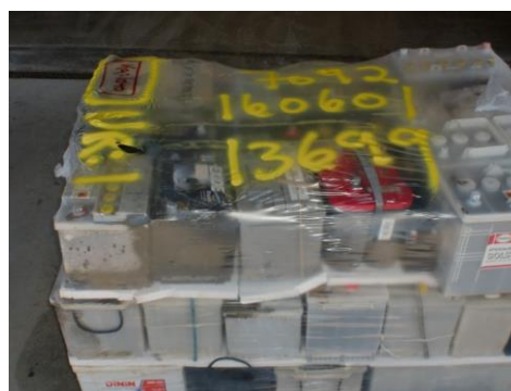
Blybatterier, ferdig pakka
