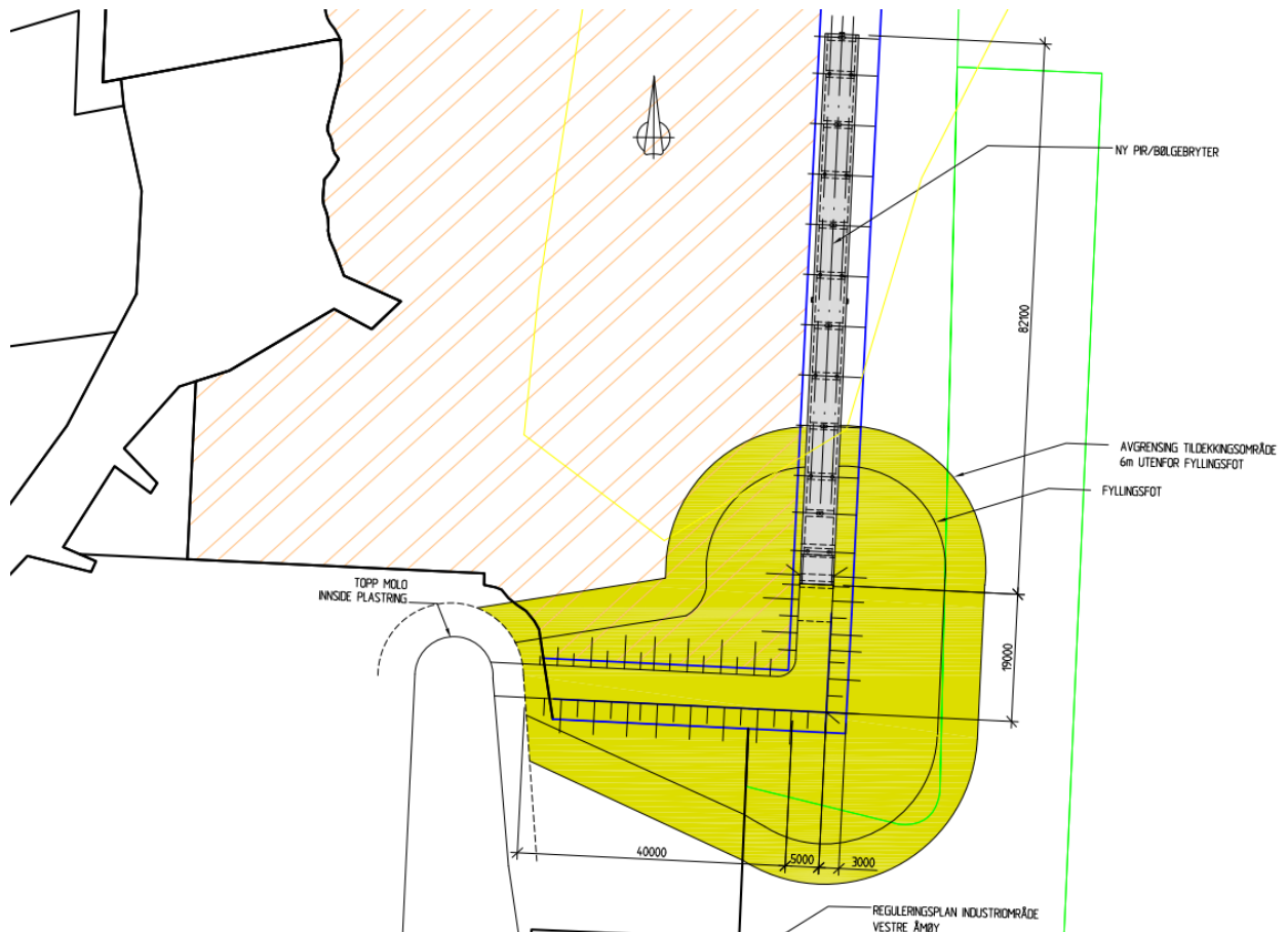
Figur 3: Utklipp fra vedlegg til brev av 23.05.2023 som viser planlagt område for tildekking med rene masser. Området strekker seg ca. 6 m utenfor planlagt fyllingsfot.
