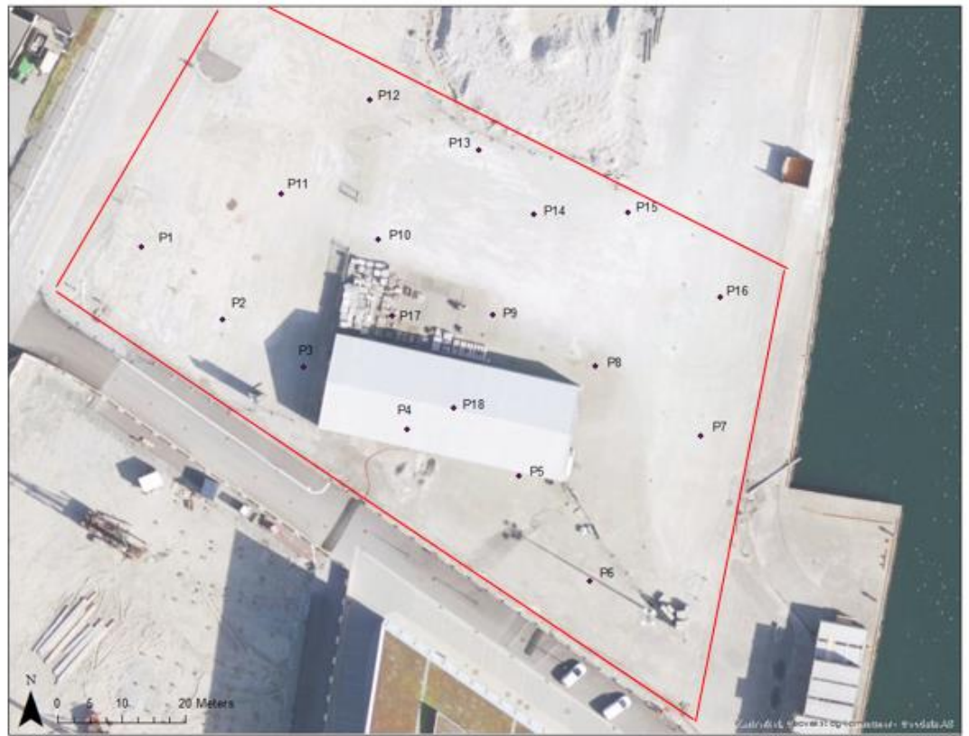
Figur 5: Oversikt over prøvepunkter fra den miljøtekniske grunnundersøkelsen. Rødt polygon viser yttergrensen på tiltaksområdet. Huset som ligger under punkt P4 og P18 var allerede fjernet. En høyspentledning ligger nedgravd et sted vest for P11 og P12. Kart fremstilt med punktkoordinater i ArcGIS.
