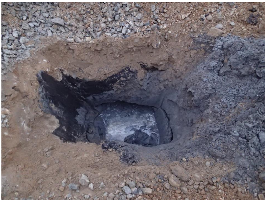
Figur 7: Typisk profil i gravesjaktene på tiltaksområdet med asfalt øverst, etterfulgt av et lag med pukk, og hovedsakelig sand og andre fraksjoner dypere nede. Fiberduk ved 60 cm dyp.
