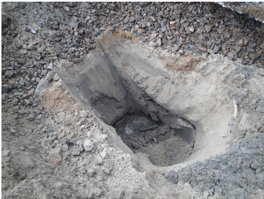
Figur 7: Typisk profil i gravesjaktene på tiltaksområdet med asfalt øverst, etterfulgt av et lag med pukk, og hovedsakelig sand og andre fraksjoner dypere nede. Fiberduk ved 60 cm dyp.
