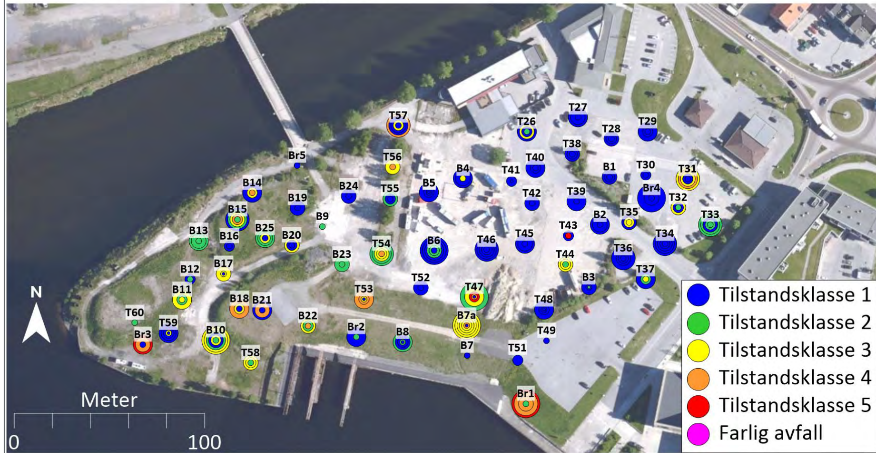
Figur 12 Viser høyeste tilstandsklasse for tungmetaller. Fra 0-1 meter (små sirkler) til 5-6 meter (største sirkler) under terreng/betongdekke.
