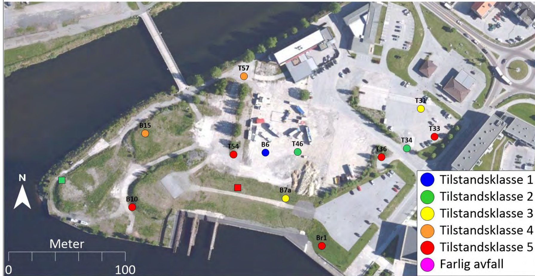
Figur 8 Resultater av prøver av masser i dybden 4 - 5 m under terreng/betongdekke. Tidligere utførte undersøkelser av Noteby/Multiconsult er vist som kvadrater i kartet. Det gjøres oppmerksom på at prøvene fra Noteby/Multiconsult ikke er analysert for alle stoffer.
