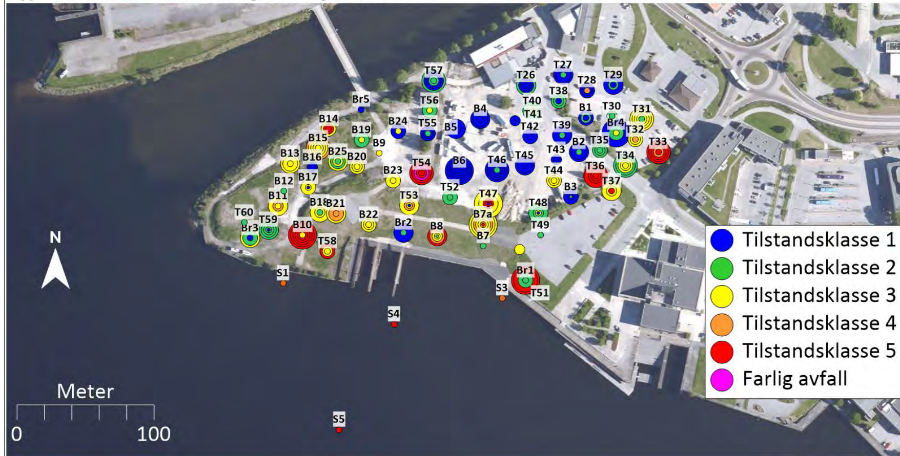
Figur 20 Viser høyeste tilstandsklasse for PAH i jord- og sedimentprøver. Jordprøver: fra 0-1 meter (små sirkler) til 5-6 meter (største sirkler) under terreng/betongdekke.
