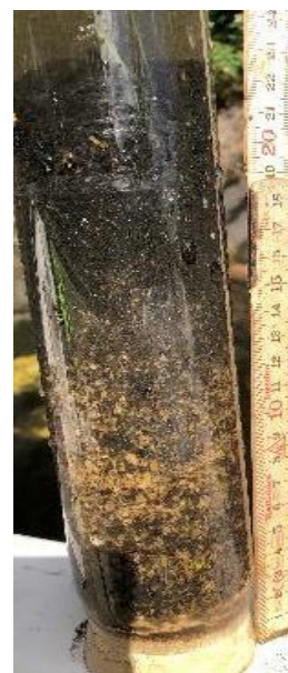
Blandprøve S1 av alle 4 prøvepunkter. For analyseresultater, se egen rapport fra laboratoriet. Lukt av anoksisisk organisk materiale.
