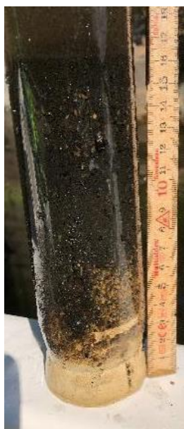
Blandprøve S1 av alle 4 prøvepunkter. For analyseresultater, se egen rapport fra laboratoriet. Lukt av anoksisisk organisk materiale.
