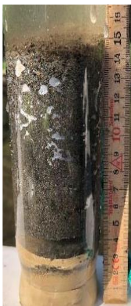
Blandprøve S1 av alle 4 prøvepunkter. For analyseresultater, se egen rapport fra laboratoriet. Lukt av anoksisisk organisk materiale.
