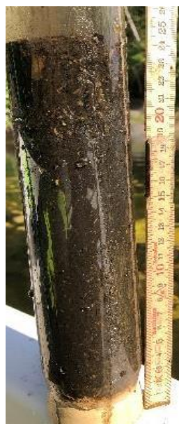
Blandprøve S1 av alle 4 prøvepunkter. For analyseresultater, se egen rapport fra laboratoriet. Lukt av anoksisisk organisk materiale.
