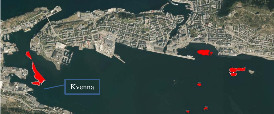
Figur 2 Grunner i Aspevågen som skal gjøres dypere i prosjekt "Innseiling Ålesund"
