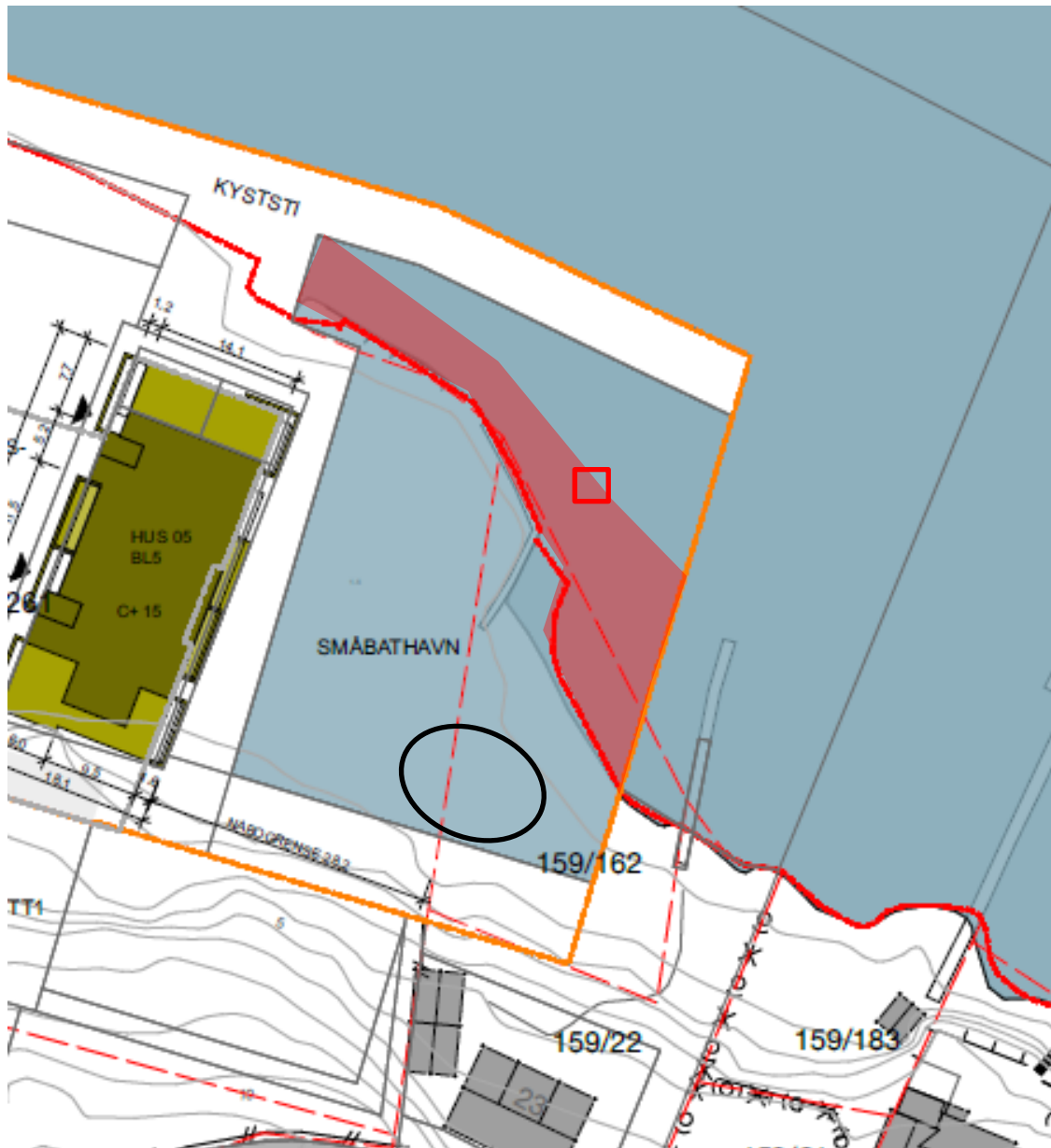
Figur 1: Utsnitt av situasjonsplan, utarbeidet av SPIR arkitekter AS, med planlagt mudringsområde inntegnet (rødskravert), og ca. prøveplassering fra prøvetaking i 2008 (pr S1). Areal for planlagt avrenning av masser er avmerket med sort sirkel
