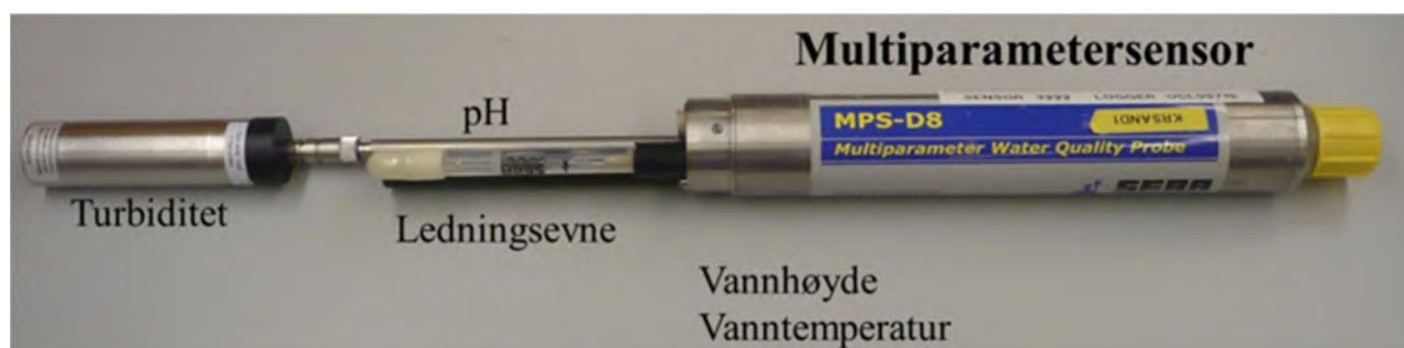
Figur 3.1. Multiparametersensor for automatisk overvåking av vannkvalitet.
