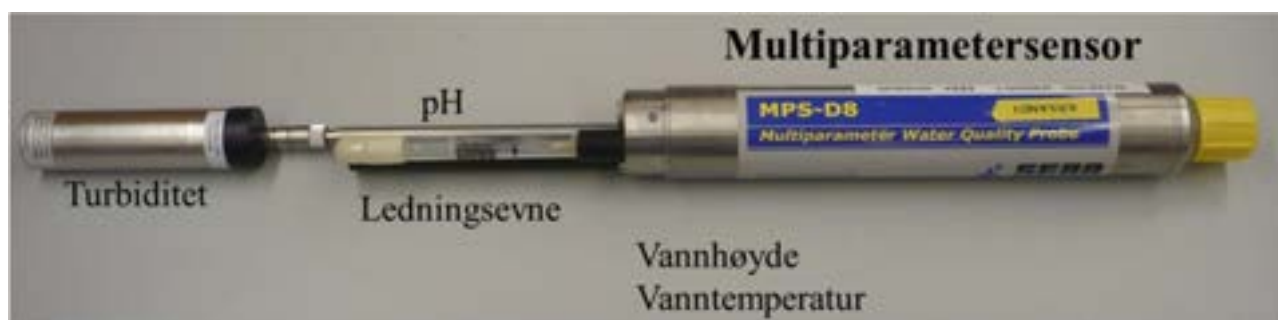
Figur 3.1. Multiparametersensor for automatisk overvåking av vannkvalitet.
