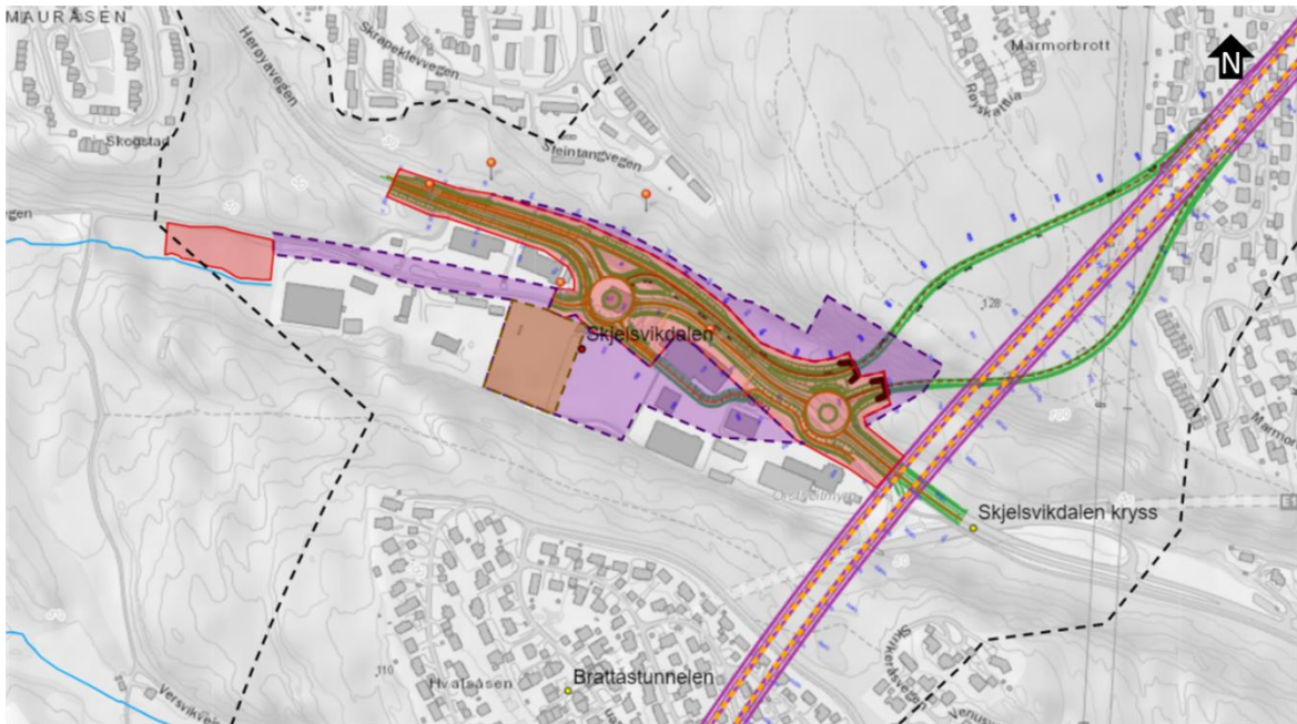
Figur 29 Kart over områder avsatt anleggsområde i Skjelsvikdalen. Rødt område markerer områder avsatt til permanent vegformål, lilla markere midlertidig anleggsområde, og brun er markering for mellomlagring av masser.
