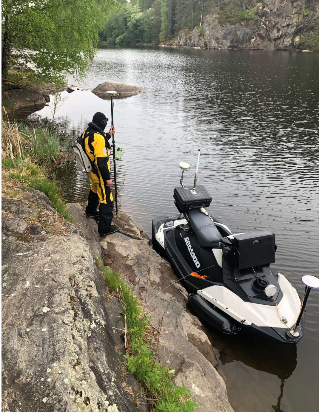
Kontrollmåling av vannspeilets høyde, like nedenfor Skotfoss kirke.
