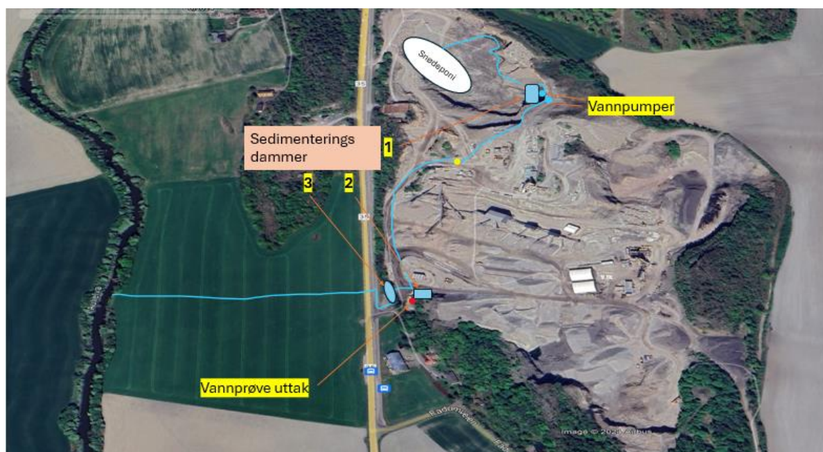
Figur 7 Prinsippkisse for håndtering av overvann og smeltevann på anleggsområdet. Blå prikker markerer vannpumper, gul prikk markerer kum, blått markerer sedimentasjonsbasseng og vannrør eller grøfter som leder vannet mellom bassengene.
