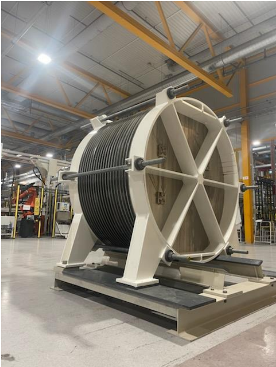
Figur 4-1 Ferdigmontert elektrolysør bestående av flere elektroder. Hver elektrode består av 2 anodeblikk og 2 katodeblikk som monteres på en bæreplate.
