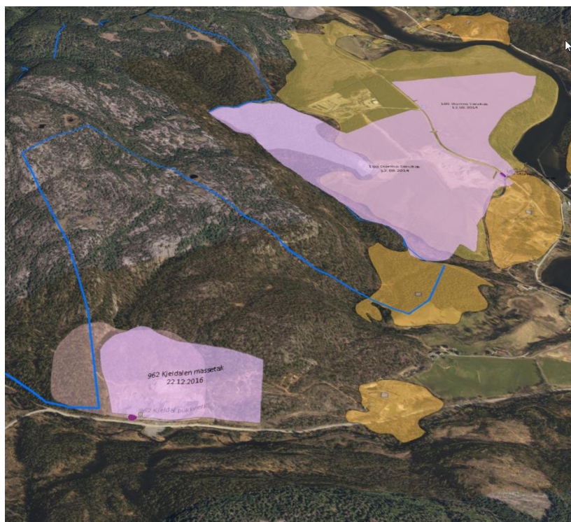
Figur 1: Figuren viser konsesjonsområde etter minerallova § 43 (rosa), sand- og grusførekomstar (oransje) og pukkførekomstar (gjennomsiktig lys rosa).
