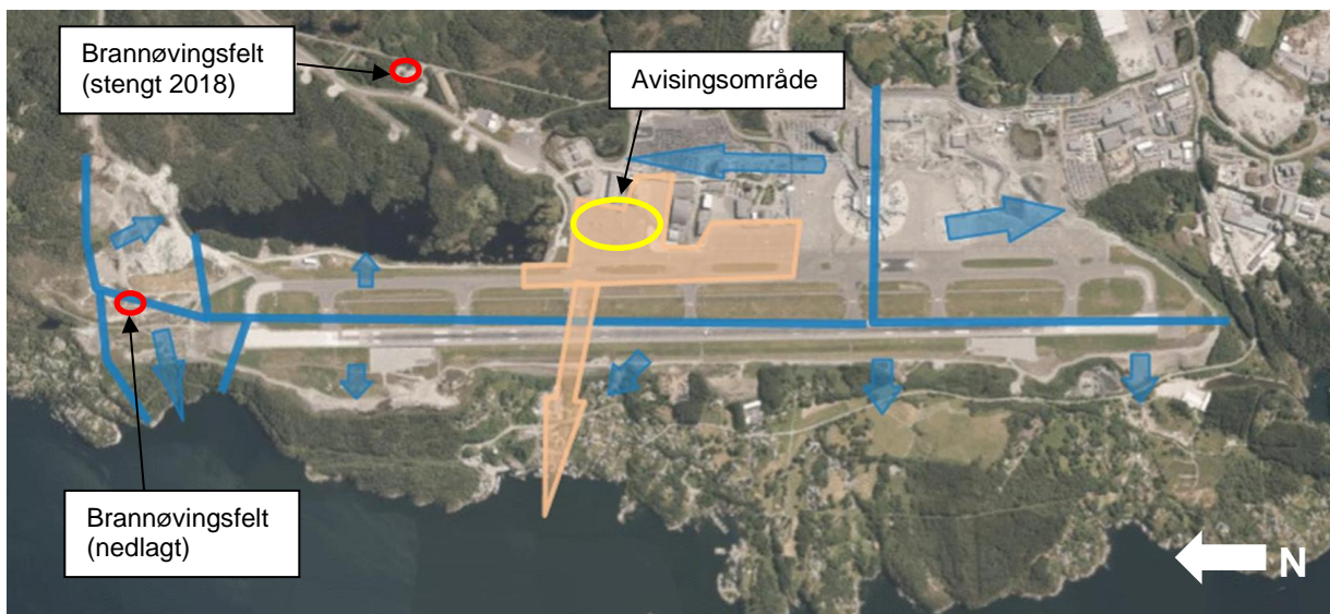
Figur 4. Avrenningsretninger (prinsippskisse) ved Bergen lufthavn (grov inndeling) vist med piler. Beige skravur indikerer områder med direkte avrenning til Raunefjorden. Plassering av avisingsområde og brannøvingsfelter (hvorav begge er stengt/nedlagt) er også vist.
