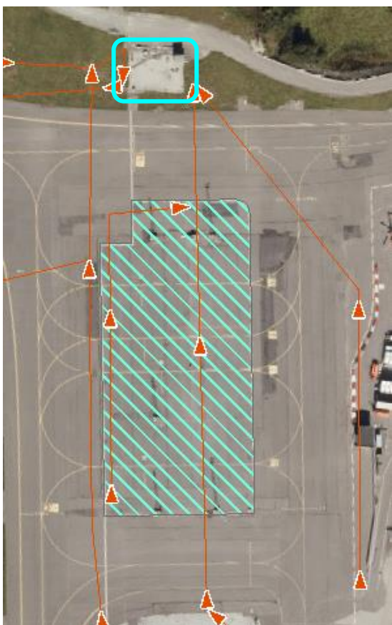
Figur 8. Plasstøpte betongkamre under bakken (plassering vist med cerise firkant) som mottar oppsamlet overvann med avisingskjemikalier fra bl.a. avisingsplattformen rett sør skravert i samme farge (røde piler).
