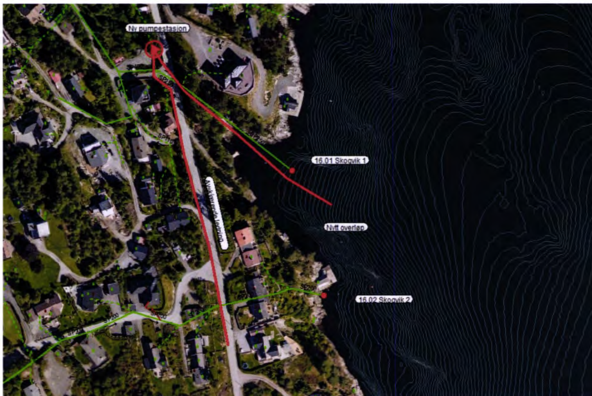
Figur 16: Flytting av Skogvik 2 til nytt overløp for pumpestasjon.
