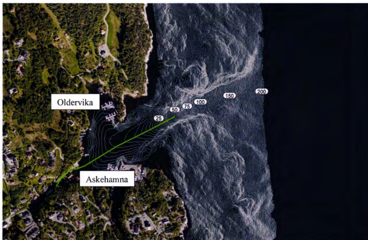
Figur 3. Planlagt plassering for hovedutslipp fra Ask RA og bunntopografi i omliggende sjøområder. Utslippsledning markert med grønn linje. Kilde: Askøy kommune 2020.
