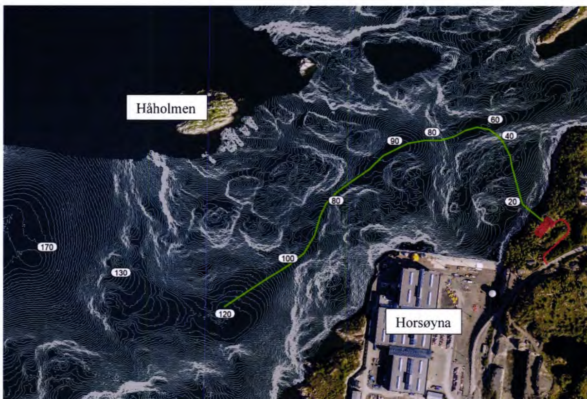
Figur 9. Planlagt plassering for hovedutslipp fra Horsøy RA og bunntopografi i omliggende sjøområder. Utslippetsledning markert med grønn linje. Kilde: Askøy kommune 2020.
