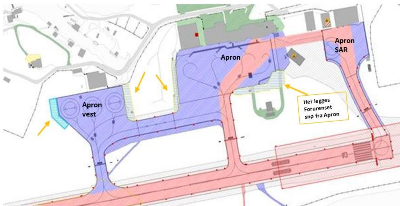
Figur 6: Sentralområdet med snødeponiene er indikert med gule piler
