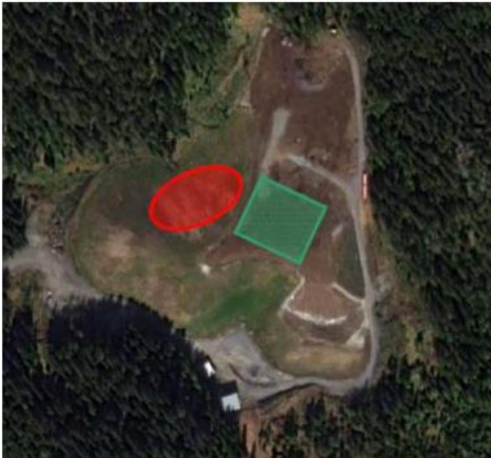
Figur 10: Område hvor det er registrert metangass er markert med rød farge, område med dokumentert akseptable utslipp er markert med grønn farge ( Golder Associates AS , 2013).)
